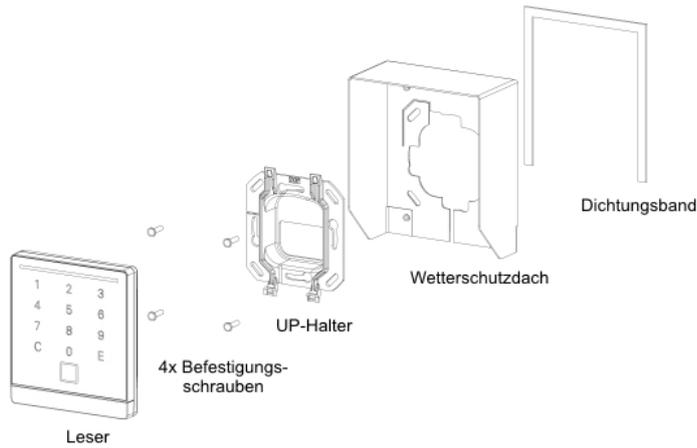
Im Lieferumfang sind ausreichend flexible, selbstklebende Dichtungsbänder beigelegt. Das Dichtungsbänder wird auf die Rückseite des Wetterschutzdaches geklebt. Es verhindert das Eindringen von Wasser und Fremdkörpern.
