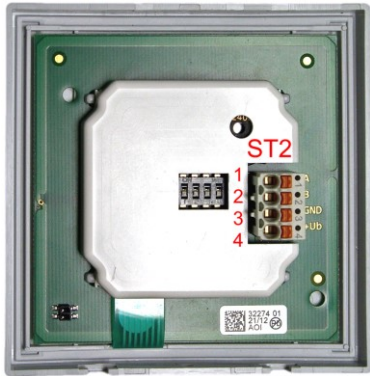
Rückseite des Lesers mit Federkraftklemme WAGO picoMAX ®eCOM
